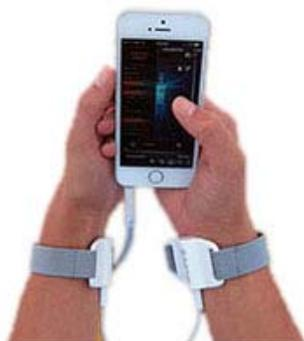
Les électrodes se relient à votre appareil grâce au câble audio fourni. Il suffit de brancher ce câble dans la sortie audio (prise jack 3.5mm) de votre appareil.
